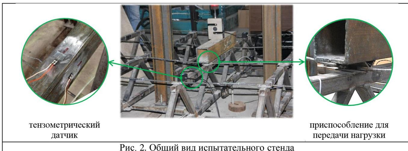
Было проведено 4 эксперимента нагружения фермы с постепенным увеличением максимальной внешней нагрузки. В эксперименте №4 произошло разрушение центрального пролета (рис. 3).
